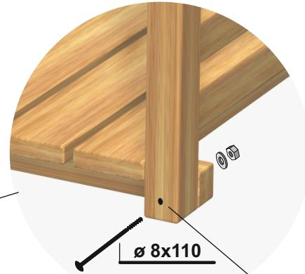
Bohrung mit **Bohrer Ø 8** beim Aufbau selbst durchführen.
