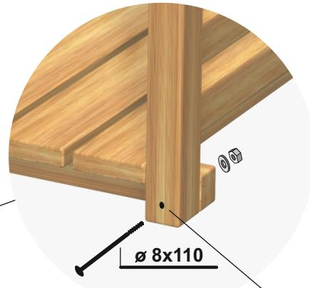
Bohrung mit **Bohrer Ø 8** beim Aufbau selbst durchführen.
