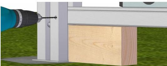
**Bohrung mit dem Ø 4 mm Bohrer:**
