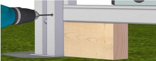
**Bohrung mit dem Ø 4 mm Bohrer:**
